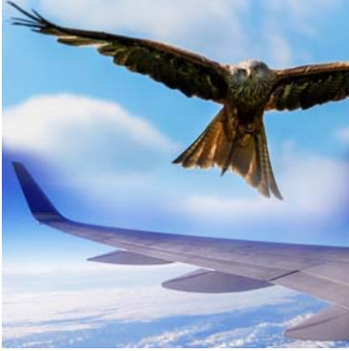
Abb. 1: Bionik: die von den Flügelspitzen inspirierten Winglets bewirken eine Reduktion des Ressourcenverbrauchs und der Emissionen.
